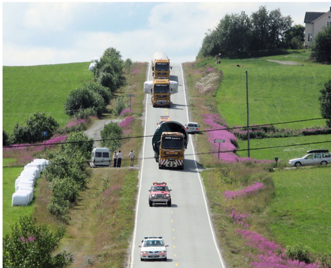
Figur 3-10 Transport av vindturbiner fra Monstad kai i Åfjord til Bessakerfjellet. Foto: Spesialtransport
